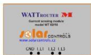
Rys 2. Opis zacisków modułu pomiarowego WATRouter M (widok z góry) w wersji SSR i MAX
