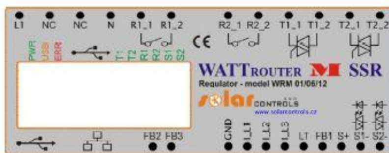
Rys 1. Opis zacisków i wskaźników LED (widok z góry). Podłączenie regulatora WATTrouter M MAX jest identyczne.
